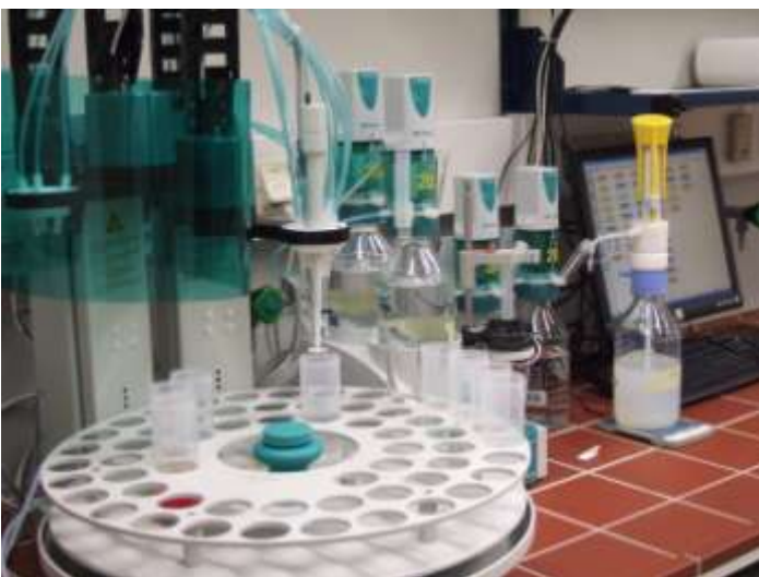
Anlage zur automatisierten Testung des Umweltverhaltens von Nanopartikeln (Verfahren in Entwicklung)
