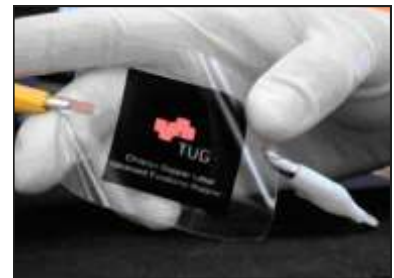
Flexibles Display hergestellt mit organischen Leuchtdioden
